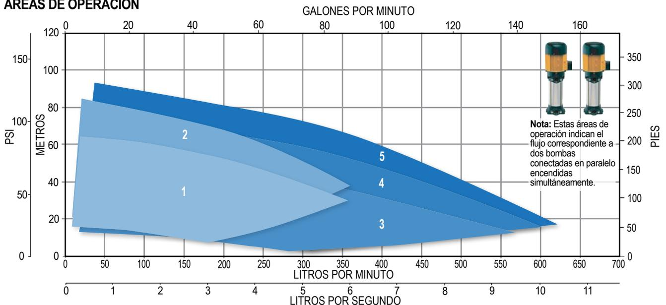
**Nota:** Estas áreas de operación indican el flujo correspondiente a dos bombas conectadas en paralelo encendidas simultáneamente.
