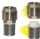
Válvula pie-check AQUA PAK (pichancha/antirretorno) en bronce con canastilla en acero inoxidable desmontable, con resorte en acero inoxidable. Conexión: Hembra
